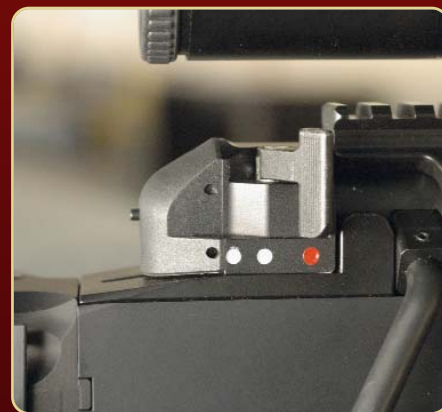
RS8 готова к стрельбе: ударник выступает из задней части затвора, флажок предохранителя расположен над красной точкой
