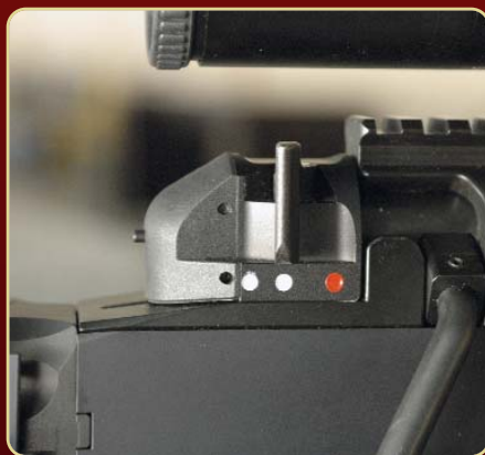
В промежуточном положении флажка предохранителя можно открыть затвор, но ударник блокирован
